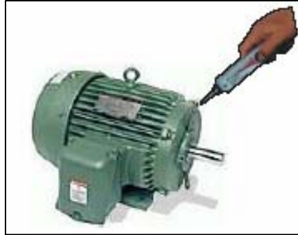
Figura 2.19 –Ilustração da Medida de Vibração em Motor Elétrico (Cortesia Microsyn)
