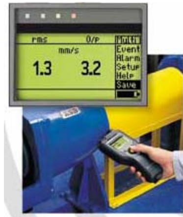
Figura. 2.22 –Ilustração da coleta de dados com a utilização de um coletor Vibscanner (Cortesia Pruftechnik AG).
