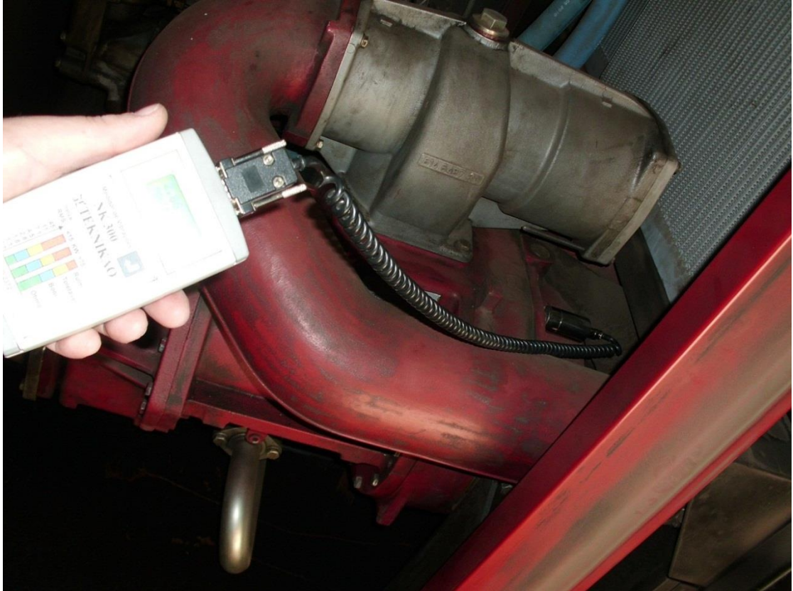
Figura 38. Medição de vibração axial do compressor Fonte: Autoria própria
