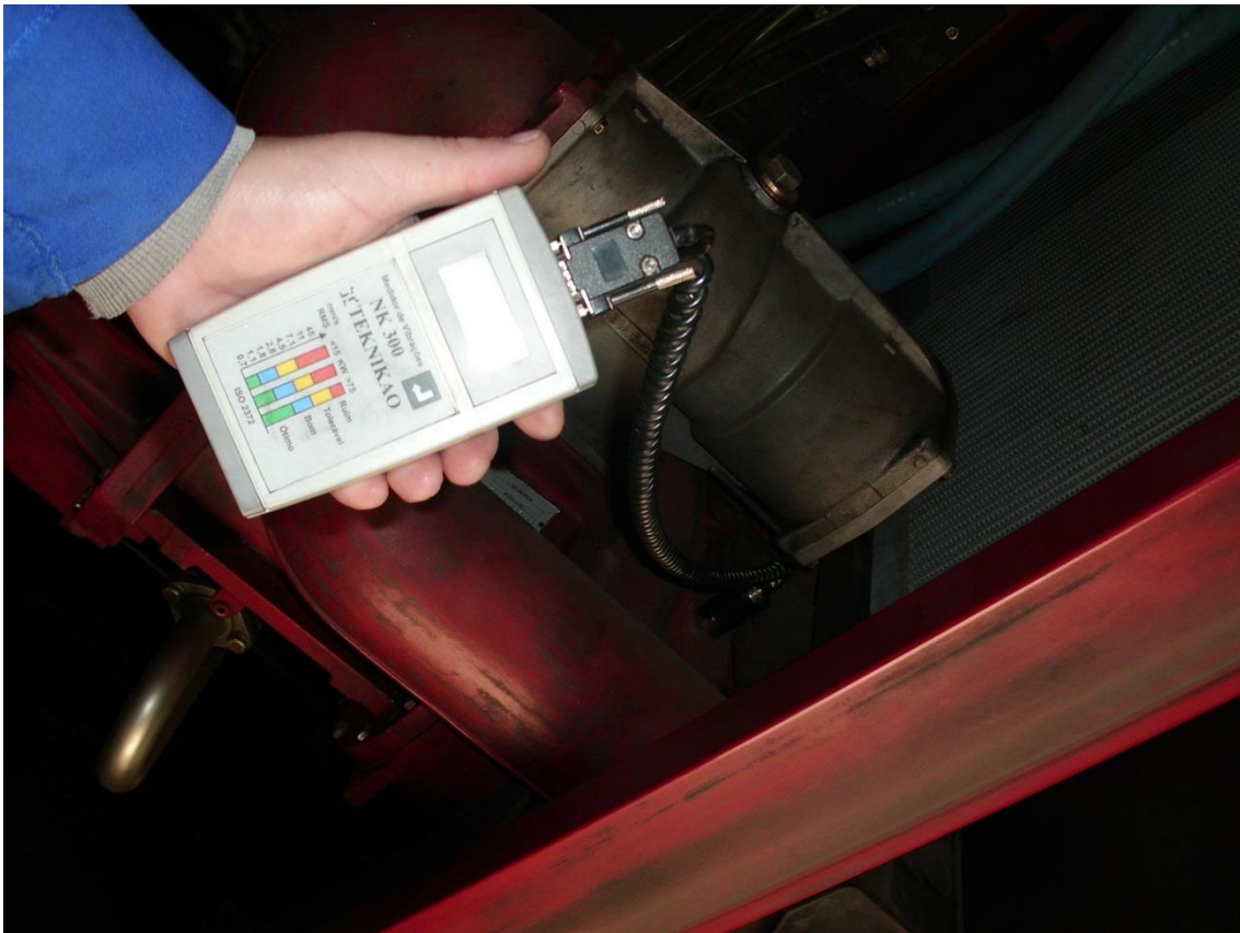
Figura 36. Medição de vibração radial do compressor Fonte: Autoria própria
