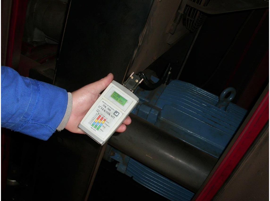
Figura 30. Medição de vibração radial do motor Fonte: Autoria própria
