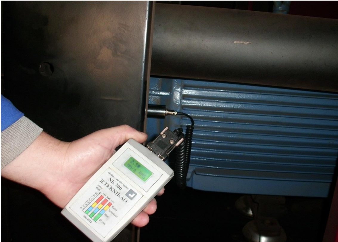
Figura 34. Medição 2 de vibração axial do motor Fonte: Autoria própria
