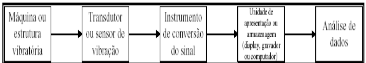
Figura 22. Esquema básico para medição de vibrações Fonte: SOEIRO, S. Newton. Curso de fundamentos de vibrações e balanceamento de rotores. 2008.
