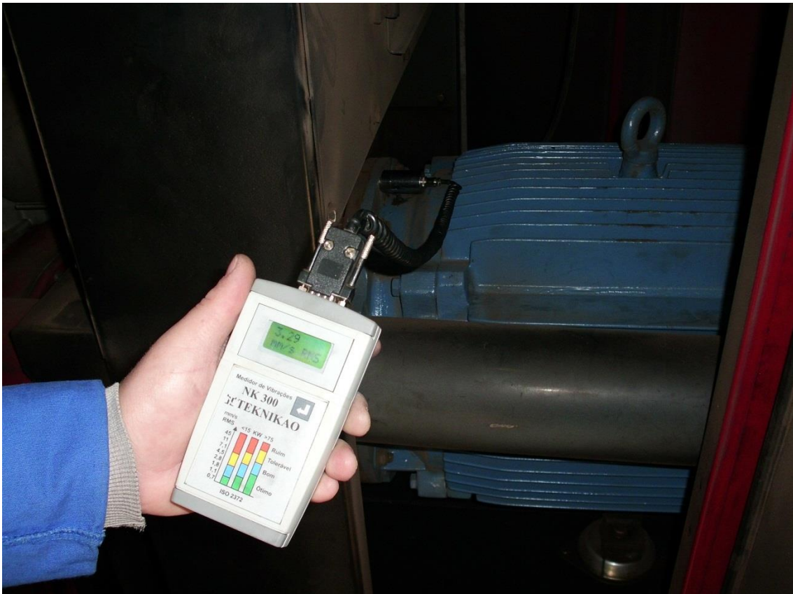
Figura 33. Medição de vibração axial do motor Fonte: Autoria própria
