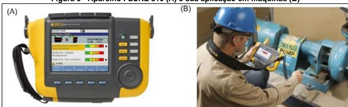
Figura 9 - Aparelho FLUKE 810 (A) e sua aplicação em máquinas (B)
