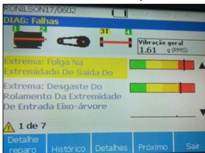
Figura 28 – Análise A5 obtida com a simulação de desbalanceamento
