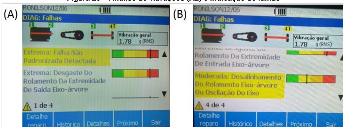
Figura 20 – Análise de vibrações (A2) e indicação de falhas
