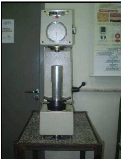
**Figura 29 – Durômetro de marca Panambra.**
