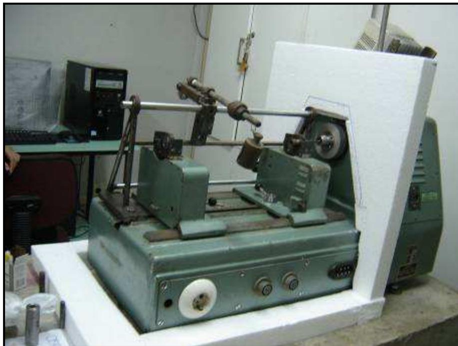
**Figura 35 – Equipamento de ensaio tribológico revestido com isopor.**
