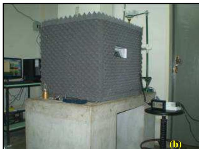
**Figura 36 – Equipamento de ensaio tribológico revestido com isopor e espuma acústica D45 (a), e visão geral do equipamento em funcionamento (b).**
