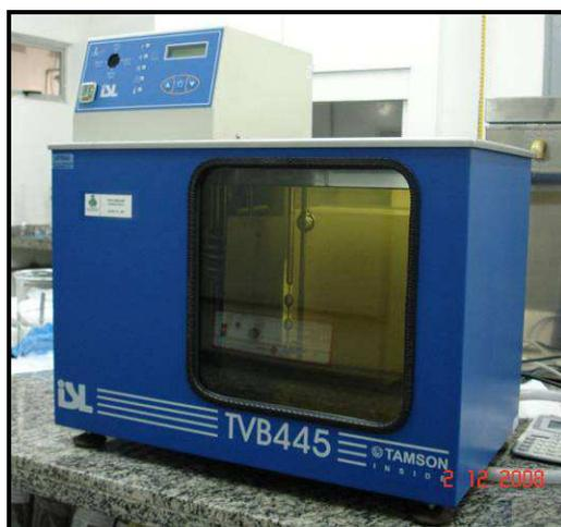
**Figura 30 – Viscosímetro modelo TVB 445.**
