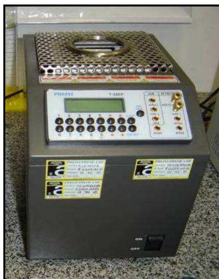
**Figura (D):** Calibrador digital de temperatura de bloco seco, marca Presys T-350P.
