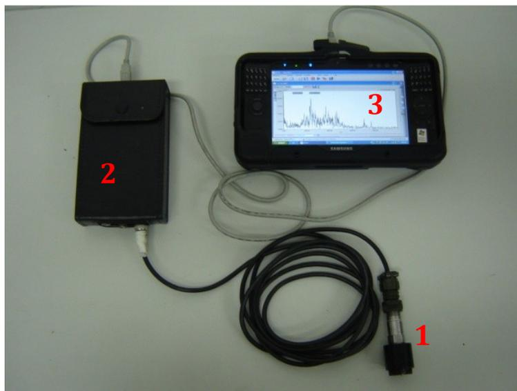
Figura 4.4 – Sistema de análise de vibrações composto por: 1. Acelerômetro piezoeletrico; 2. Conversor analógico/digital; 3. Computador portátil com software de processamento de sinais.
