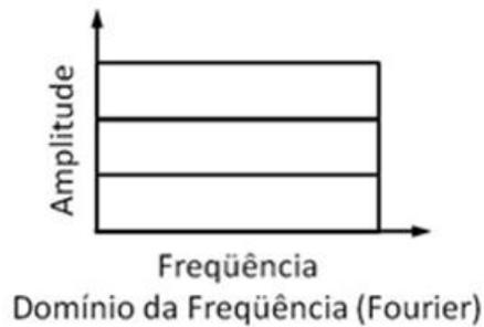
Figura 2.1 - Resolução tempo-freqüência para a Transformada de Fourier.
