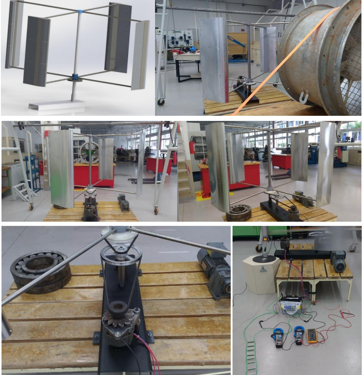
Figura 28: Conjunto Aerogerador Montado Fonte: do autor
