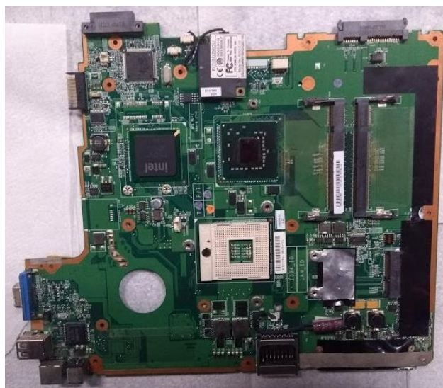
Figura 5– Amostra de PCI de notebook antes do fracionamento.
