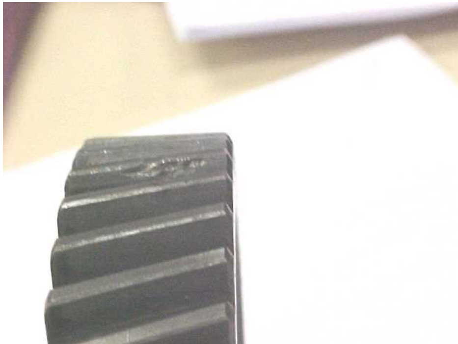
FIGURA 58 – Engrenagem conduzida da segunda marcha com batida em um dente
