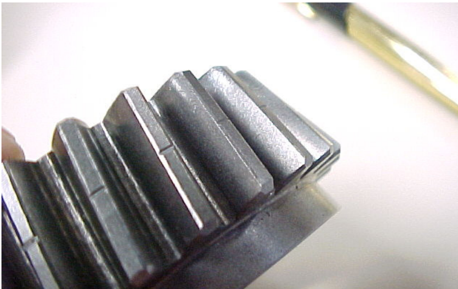
FIGURA 41 – Foto da engrenagem reversora da ré com falha no perfil do dentado
