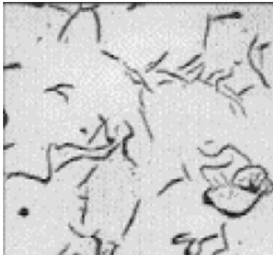
Figura 3 - Grafita Tipo D, tamanho entre 60 e 120 microns, hipoeutético 100x (RADZIKOWSKA, 2000)
