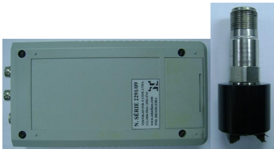
Figura 42 - Foto transdutor e acelerômetro piezoelétrico utilizado na medição de vibração em todos os testes realizados.
