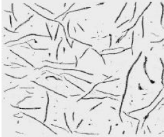
Figura 2 - Grafita Tipo A 100x (ASTM, 1985)
