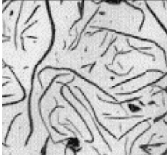
Figura 4 - Grafita Tipo D, tamanho da grafita entre 250 e 500 microns, hipoeutético 100x (RADZIKOWSKA, 2000)
