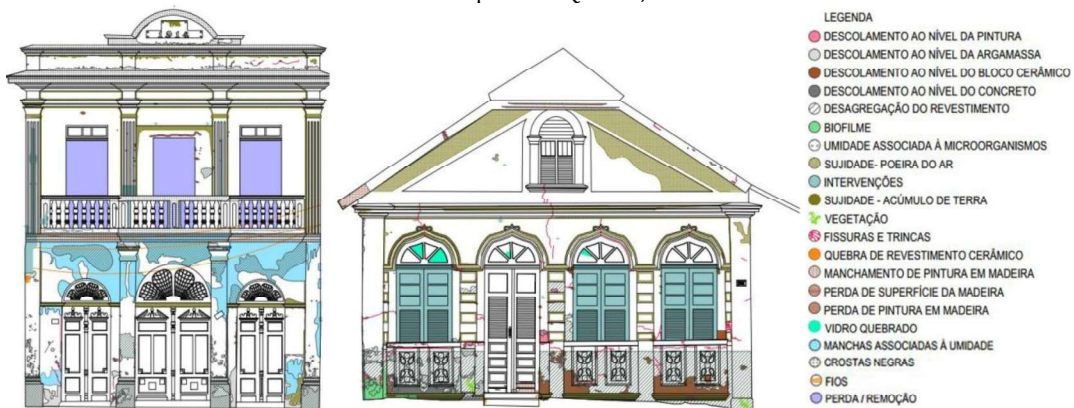
Figura 9 - Identificação das manifestações patológicas nos edifícios 24 e 29 respectivamente Fonte: Adaptado de Florenzano, 2016
