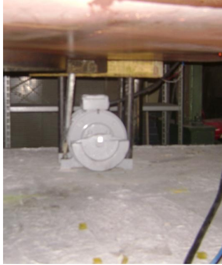
Fotografia 4. Fonte de excitação com massas desbalanceadas. Fonte: Acervo dos autores
