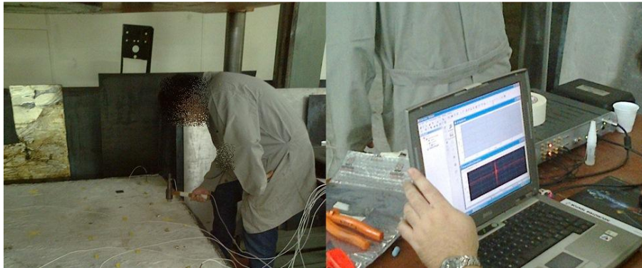
Fotografia 6. Excitação da placa com martelo de impacto e sistema de aquisição de dados. Fonte: Acervo dos autores.
