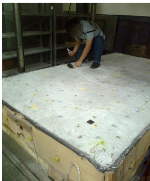
Fotografia 9. Especialista realizando a colagem dos acelerômetros.
