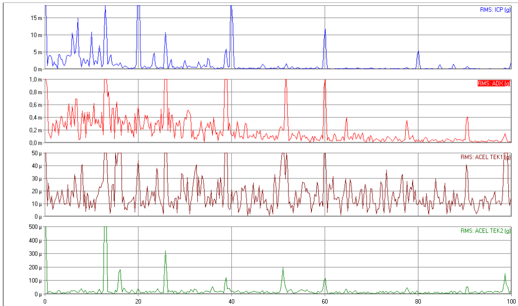
Gráfico 4. Espectro global visto pelos acelerômetros ADX, ICP, TEK1 e TEK2 para a frequência de excitação de 12,0 Hz.
