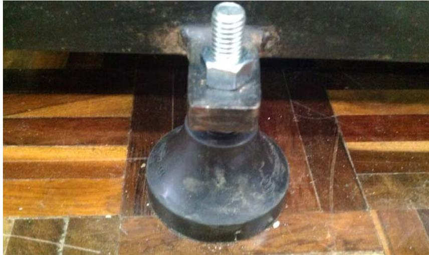
**Figura 3-1 – Vibra-stop utilizado na base metálica do motor**
