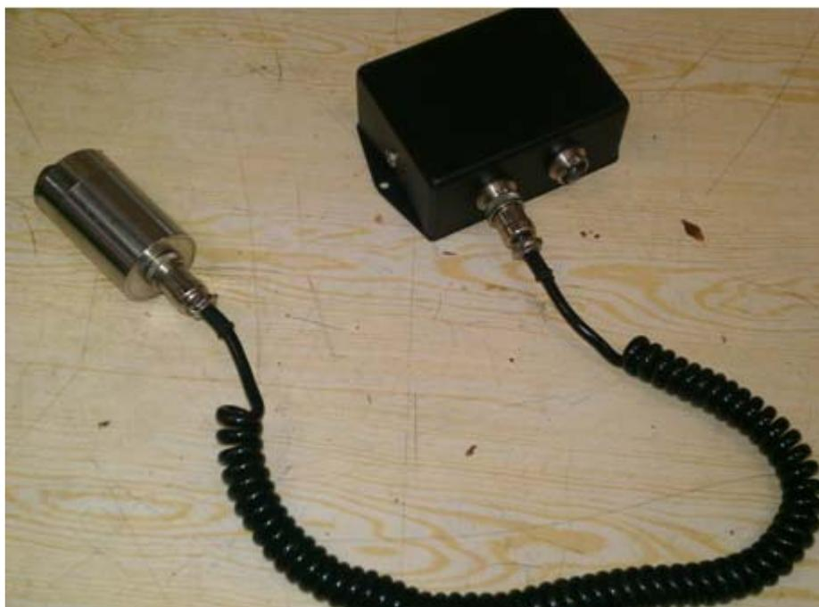
**Figura 3-10 – Alimentação e conversão de conectores do sensor IRD 970**
