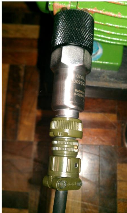
**Figura 3-7 – Sensor acelerômetro HS-100**
