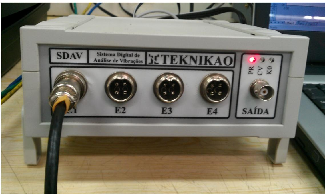
**Figura 3-6 – Analisador de vibrações da Teknikao com quatro canais**
