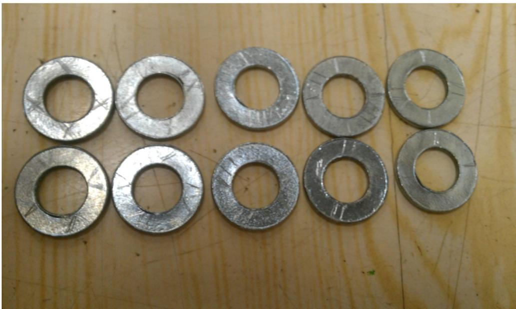
**Figura 3-4 – Arruelas utilizadas para simulação de desbalanceamento**
