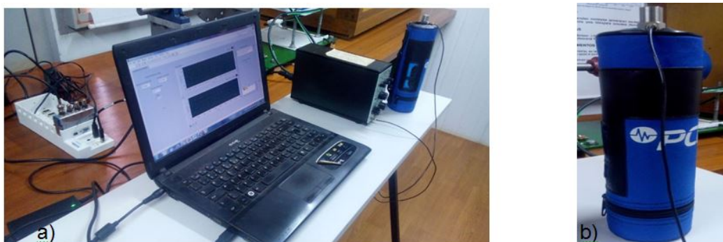
Figura 80 – a) Cadeia de medição montada para aquisição do sinal de aceleração no Handshaker. b) Posição do acelerômetro.
