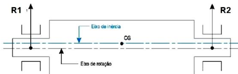
Figura 9 – Resultantes nos mancais provocadas por desbalanceamento estático. FONTE: (COELHO, 2013)
