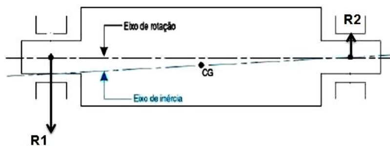
Figura 17 – Resultantes nos mancais devido ao desbalanceamento dinâmico. FONTE: (adaptado: (COELHO, 2013)).
