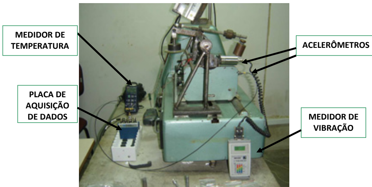
Figura 22 – Instrumentação do tribômetro
